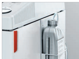
Lubrification automatique des cylindres de coupe.
