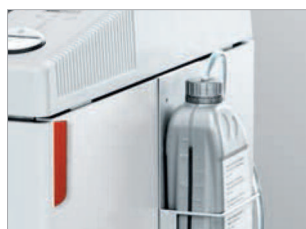
Lubrification automatique des cylindres de coupe.
